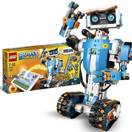
Robotikan robotak eraiki eta motorrak, sentsoreak eta LEGOzko piezak erabiliz programatzen dira. Tablet gailua erabiltzen da.
